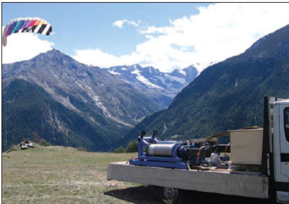
Figura 5 - Sperimentazione del prototipo di generatore eolico ad aquilone del tipo “a yo-yo” realizzato dalla KiteGen.
