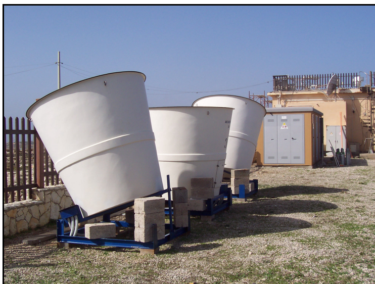
Figura 28 - Postazione SODAR Doppler triassiale di Lampedusa.
