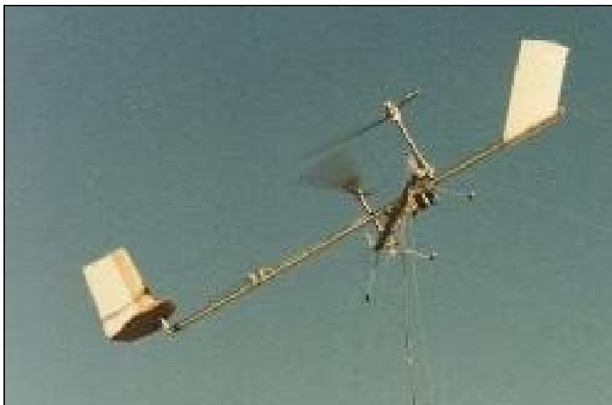
Figura 23 – Il prototipo del FEG in volo con assetto inclinato durante la fase di generazione sotto l'azione del vento.
