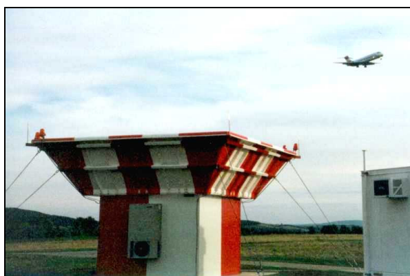
Figura 50 - Esempio di installazione di un wind profiler
