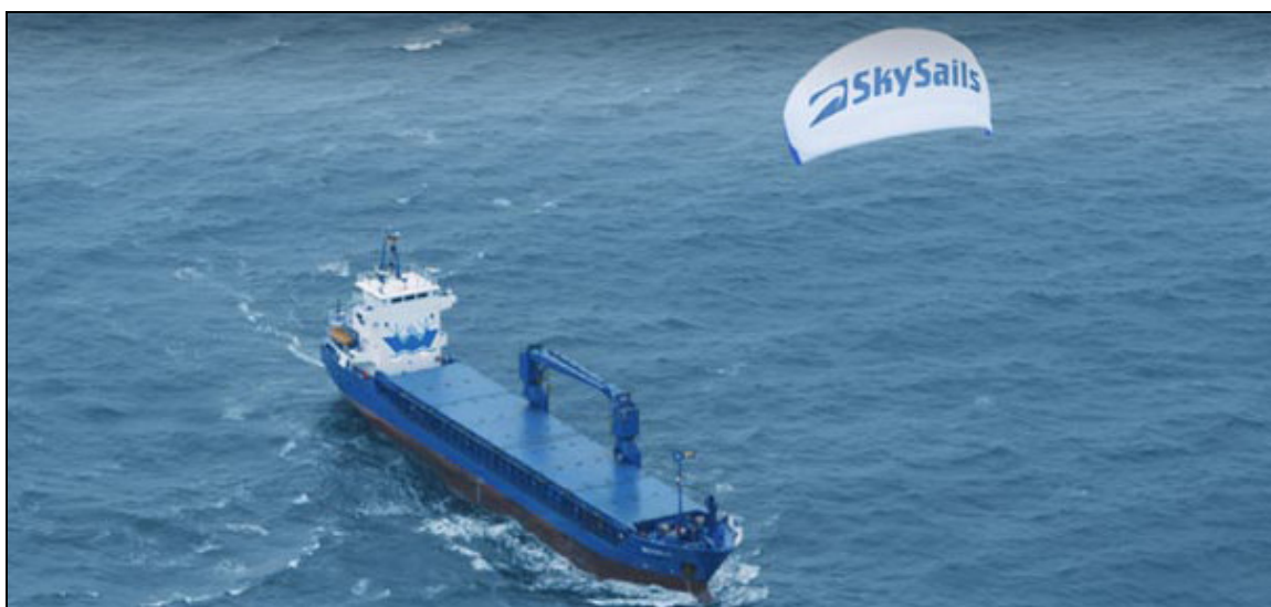
Figura 3 - Sistema di propulsione integrativo ad aquilone applicato su una motonave dalla società SkySails di Amburgo (foto SkySails).
